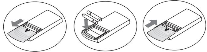
1. Öffnen Sie den Batteriefachdeckel, indem Sie ihn in Pfeilrichtung schieben.
